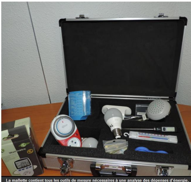
La mallette contient tous les outils de mesure nécessaires à une analyse des dépenses d'énergie.
