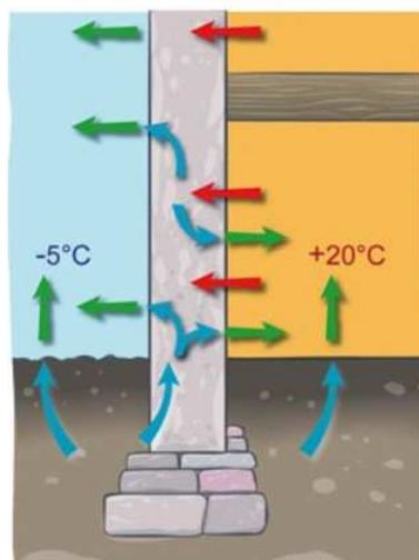
Fonctionnement hygrothermique d'un mur traditionnel isolé par l'intérieur.
