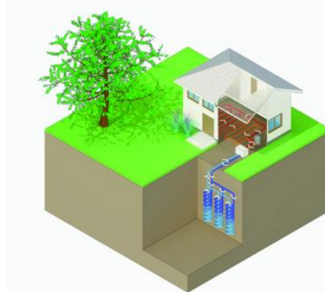
Géothermie sur échangeurs compacts (corbeille)
