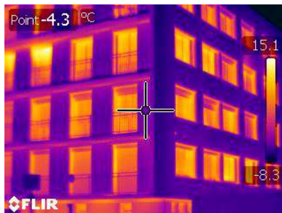
isolation par l'extérieur source ALEC42
